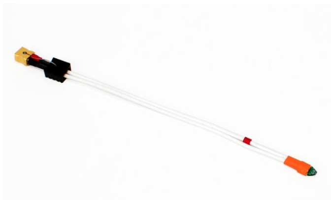
TriMode™ ロング・リーチ・ソルダ・チップ (75Ω 抵抗) メモリ・チップ・インターポーザ (100Ω 抵抗を内蔵) と合わせて使用する高性能ソルダ・チップ。最高周波数帯域：20GHz
