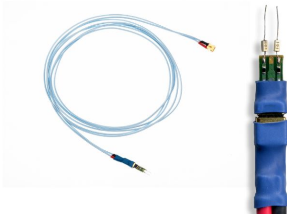
TriMode 耐温度チップソケット・ケーブル XL (150cm) (020-2960-XX) と Arb Filter を併用することで、 -55\sim+150^{\circ}\text{C} の環境で使用可能。最高周波数帯域：10GHz (DSP を使用)
