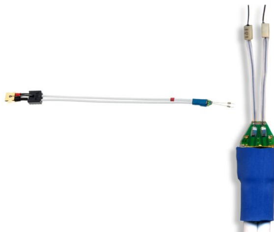
TriMode 拡張抵抗ソルダ・チップはんだ付けが簡単なソルダ・チップ。最高周波数帯域：7GHz
