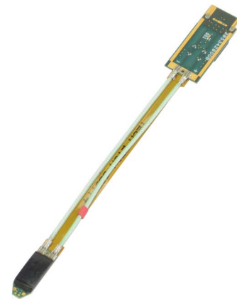
P77STCABL 型はんだ付け用アクセサリは、リーチの長い、柔軟なケーブルを持ち、チップ上にアクティブ・バッファ増幅器を備えている
