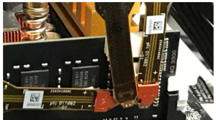
P77STFLXB 型はんだ付け用フレックス回路アクセサリは、Nexus 社のXH シリーズ・インターポーザを使用することで、DDR4/LPDDR4 の電気検証用プロービング・ソリューションとして使用可能
