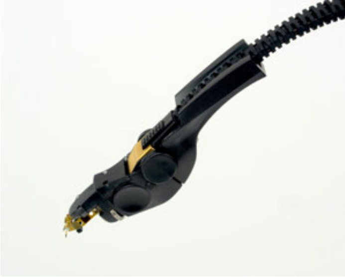
P77BRWSR 手持式点测探头附件支持手动探测或夹持探测，并可以调节尖端间距。高达 16 GHz 的带宽。
