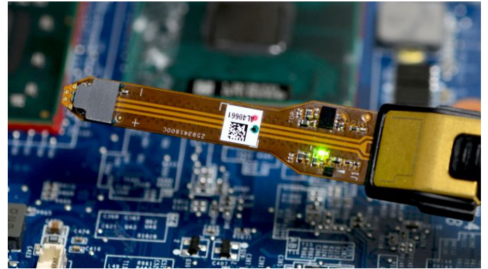
P77STFLXA 型はんだ付け用、フレックス回路アクセサリはチップ上にアクティブ・バッファ増幅器を装備
