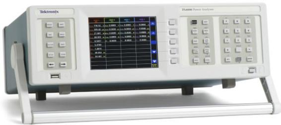
텍트론릭스 PA4000 전력 분석기는 고도로 정확한 다중 채널 파워, 에너지 및 효율성 측정 기능을 제공합니다. 정밀 매칭 입력, 고유의 스파이럴 션트(Spiral Shunt™) 기술 및 고급 신호 처리는 고도로 변조된 파형과 최고 10의 파고율에서도 높은 정밀도를 제공합니다. 다기능 PA4000은 포괄적인 전력 계측 기능을 제공합니다. 듀얼 전류 션트는 마이크로와트에서 킬로와트 단위에 이르기까지 최적의 분해능을 제공합니다. 기본 장비에 최대 100 차 고조파에 대한 고조파 분석과 토크 및 속도 입력을 사용한 모터 분석 기능이 포함되어 있습니다. 모든 PA4000 전력 분석기에는 데이터 수집 및 분석에 활용할 수 있는 여러 개의 PC 인터페이스, PC 소프트웨어 및 USB 플래시 드라이브 지원이 포함됩니다.
