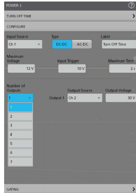
ターン・オフ時間測定の設定画面は複数の出力に対応している
