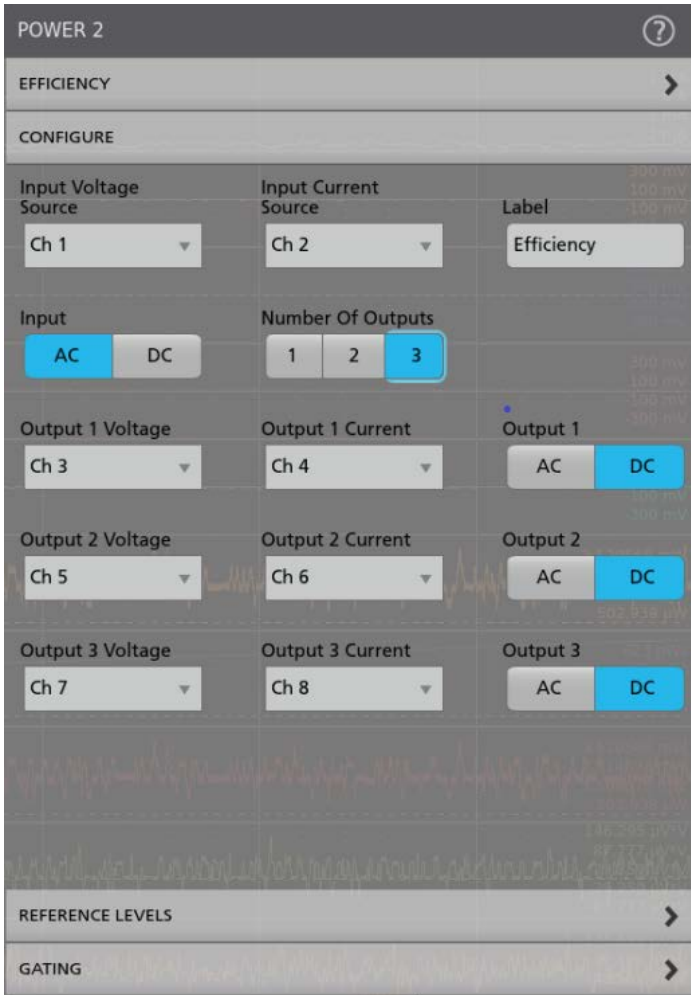
複数の電力変換デバイス (AC-DC、AC-AC、DC-DC、DC-AC) をテストするための効率測定設定
