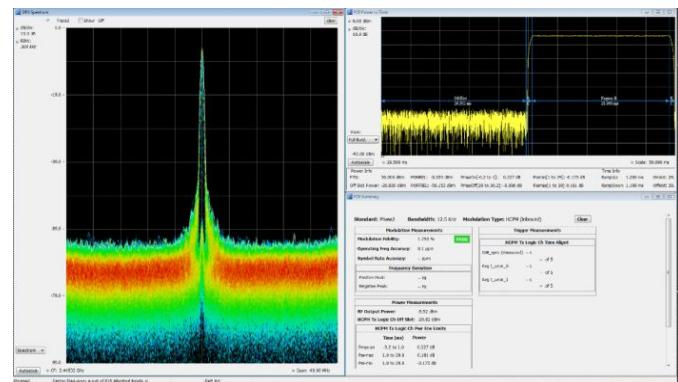
Всеобъемлющие измерения сигналов WLAN выполняются просто. Ниже представлена спектрограмма сигнала 802.11g, показывающая начальную управляющую последовательность, за которой следуют основные пакеты сигнала. Автоматически обнаруженная для пакета модуляция 64 QAM отображается в виде констелляционной диаграммы. В сводных данных указана амплитуда вектора ошибки (EVM), равная -33,24 дБ (ср.кв.), и мощность пакета 10,35 дБм.
