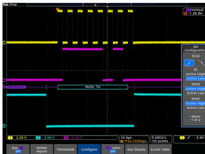
Configuration de bus SPI, avec les options de configuration pour les sources de bus.
