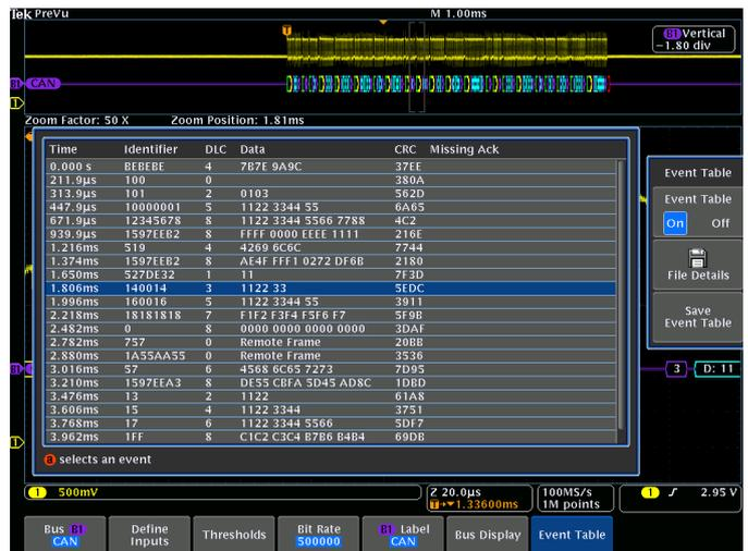
Tableau des événements montrant un identificateur, un DLC, des données et un contrôle de redondance cyclique décodés pour chaque paquet CAN d'une longue acquisition
