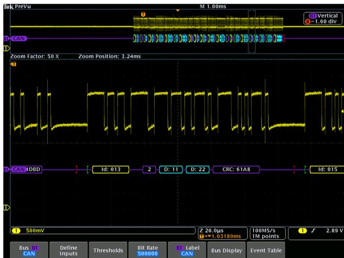
Affichage d'un bus CAN avec codage couleur montrant les composants Départ, DLC, Données, Contrôle de redondance cyclique (CRC) et Arrêt du signal série.
