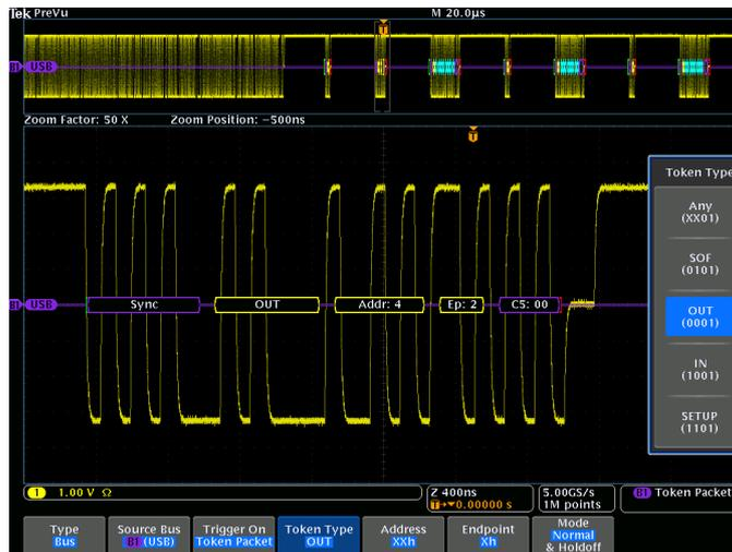
Déclenchement sur PID spécifique sur un bus USB FS.
