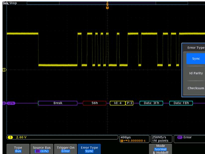
Déclenchement sur une erreur de synchronisation sur le bus LIN.
