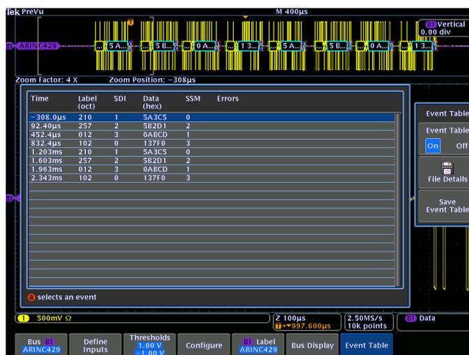
Table des événements pour le bus ARINC 429 bus avec horodatage de tous les paquets capturés sous forme de tableau.
