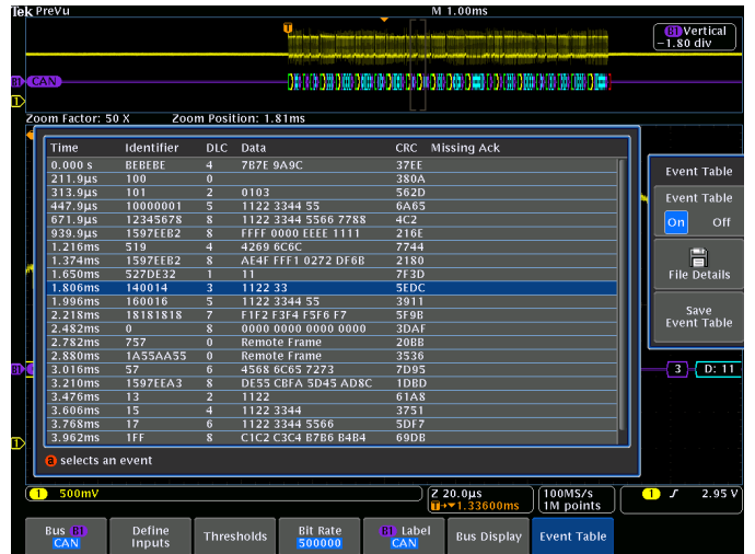
イベント・テーブル表示には、長い時間ウィンドウで取込まれたCANパケットの識別子、DLC、データ、CRCが表示されている
