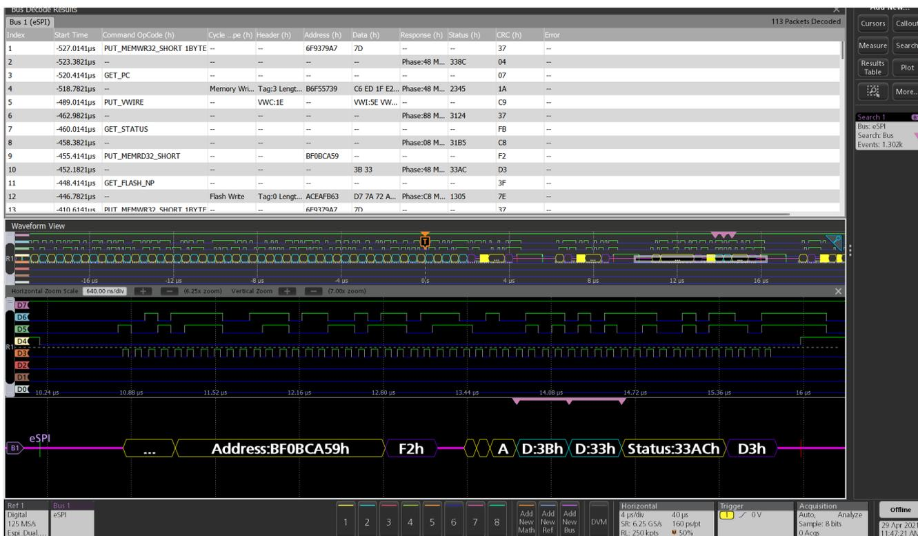
协议解码结果表为eSPI 总线上捕获的所有像素包提供了一个带时间标记的表格视图。（双IO 模式）
