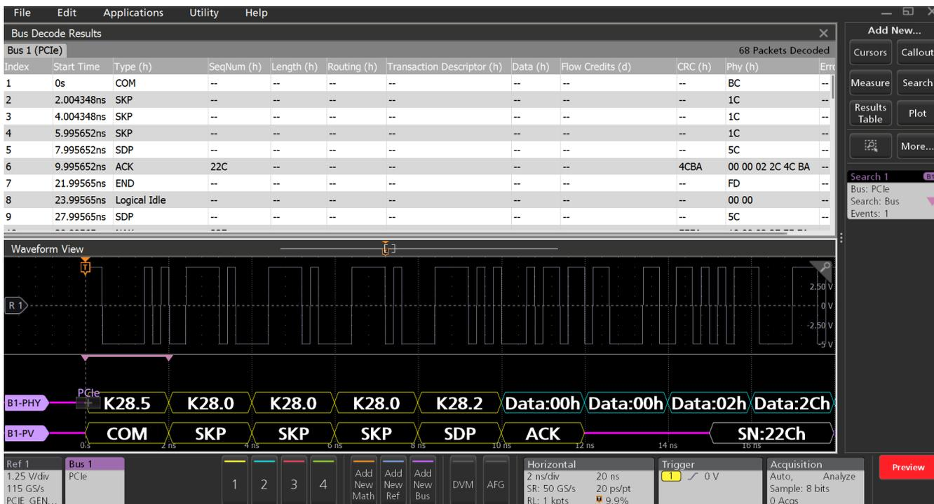
PCIe Gen 2 总线设置和MixedHex 显示，显示解码（包视图开启）。K28.5 已搜索到1 次。
