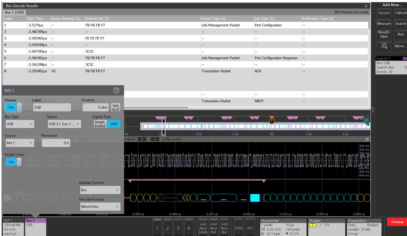
搜索 USB 总线，解码速度 USB 3.1 Gen 1 以及 TP 包的包视图开启。格线顶部的结果表。
