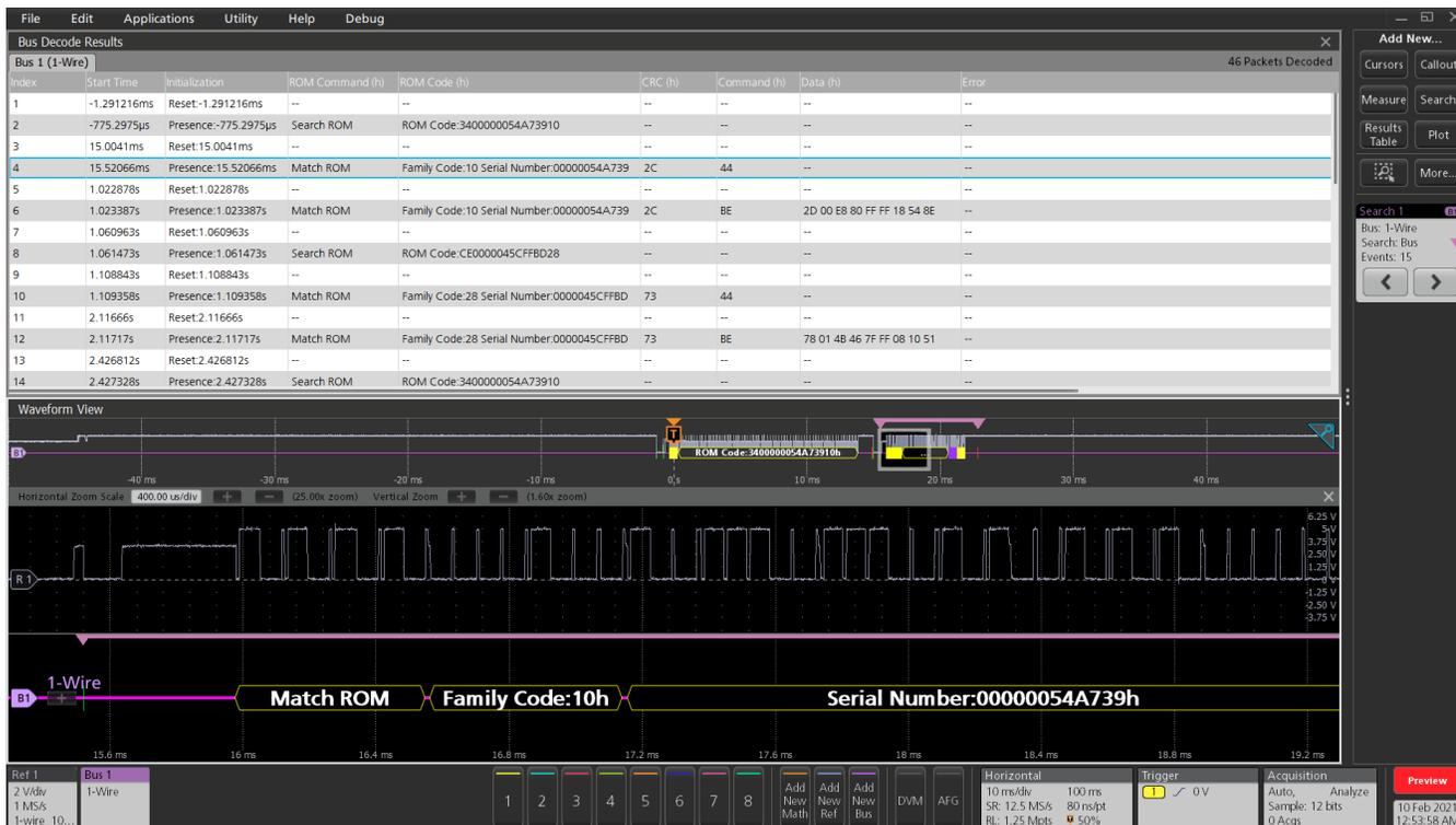
协议解码结果表为1-WIRE 总线上捕获的所有像素包提供了一个带时间标记的表格视图。
