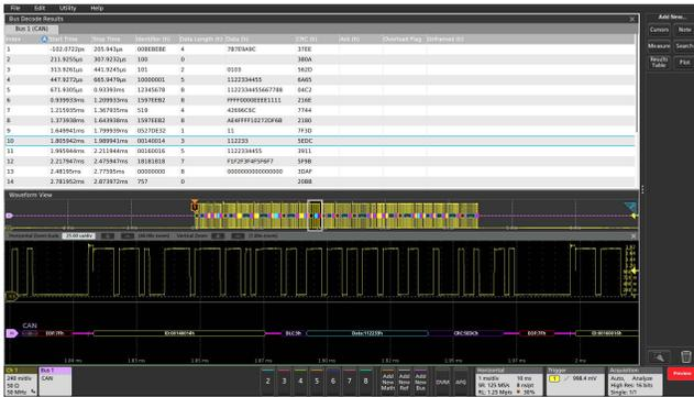
在串行总线上，单个信号中通常包括地址信息、控制信息、数据信息和时钟信息。这可导致很难发现关注的事件。选配串行应用把示波器变成强大的串行总线调试工具，自动解码和分析 I<sup>2</sup>C、SPI、eSPI、I3C 的自动串行解码和分析选项<sup>1</sup>、CAN、CAN FD、CAN XL、LIN、FlexRay、SENT<sup>1</sup>、RS-232/422/485、UART、USB 2.0、USB 3.0、USB 3.1 Gen 1、USB 3.2 Gen 1、以太网、I3C、SPMI、Spacewire、8b10b、MFC、NRZ、MIL-STD-1553、ARINC 429、I<sup>2</sup>S、LJ、RJ、PCIe Gen 1/Gen 2、PSI5、CPHY、CXPI、DPHY、SMBus、1-WIRE、EtherCAT 和 TDM。
