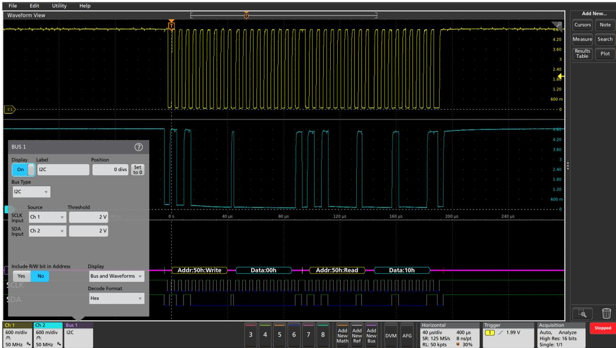
带色码的I<sup>2</sup>C总线显示，采用十六进制显示格式。
