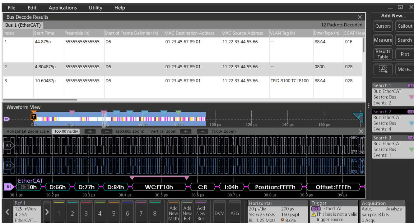
协议解码结果表为 EtherCAT 总线上捕获的所有包提供了带时间标记的表格视图。
