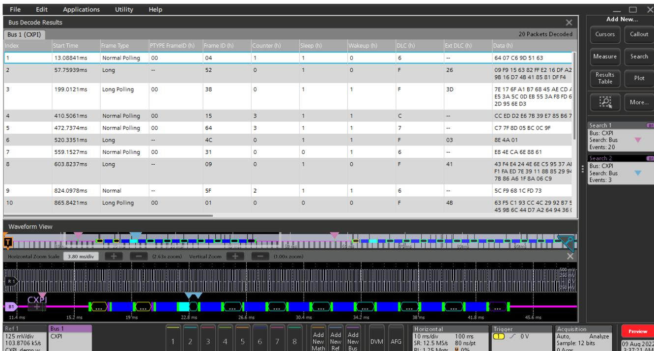
协议解码结果表提供时间标记的表格视图，显示 CXPI 总线上捕获的所有包，其中包括帧类型以及受支持的错误。
