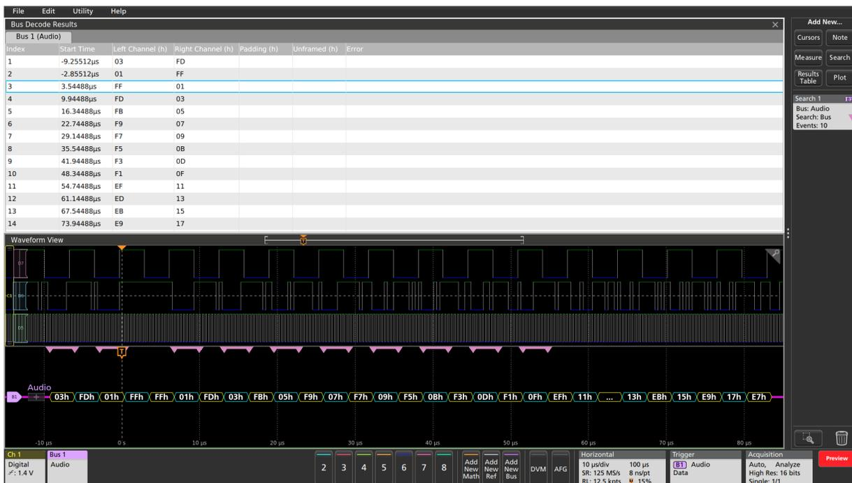
解码的I<sup>2</sup>S总线，数据值以十六进制和结果表格式显示，Wave Inspector自动搜索功能标记数据值等于0X十六进制值的所有时点。
