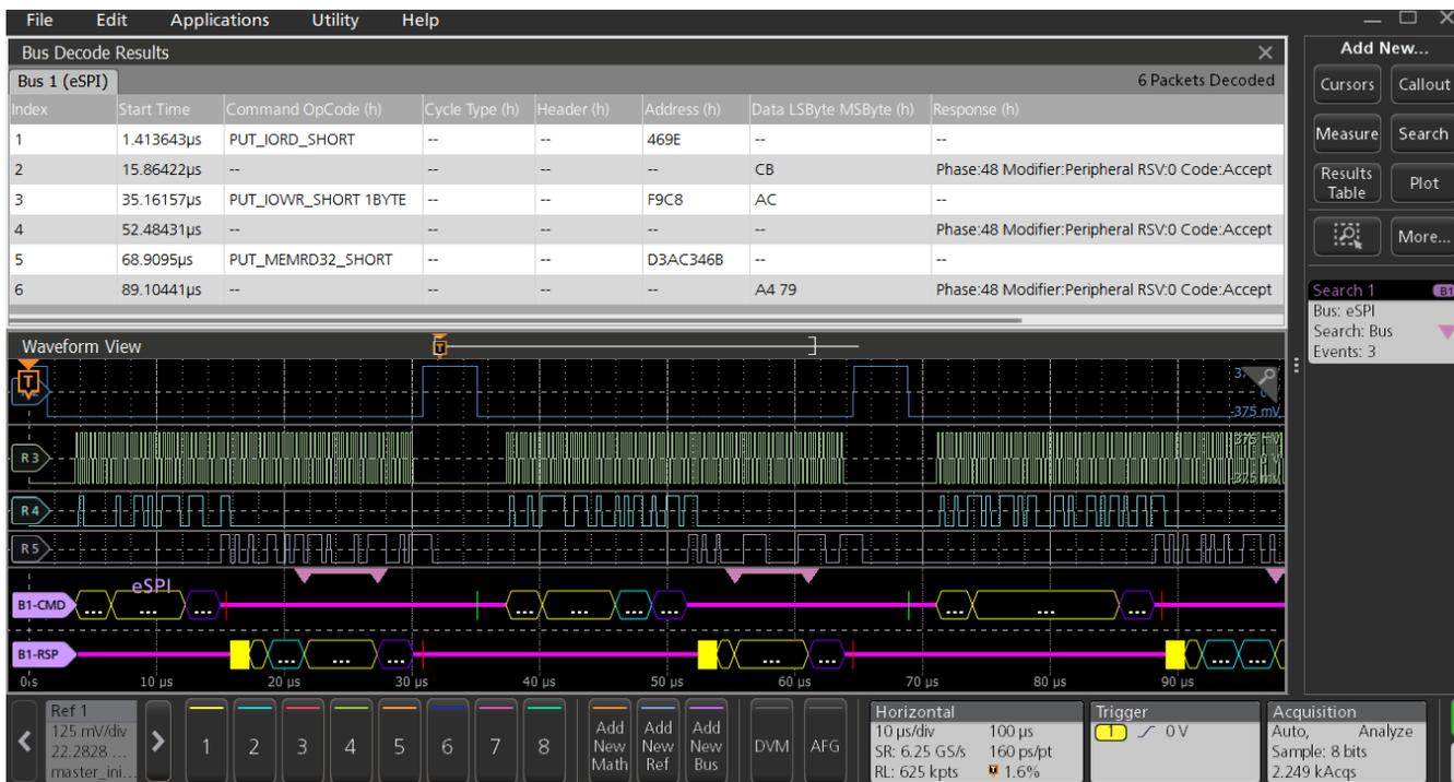
协议解码结果表为eSPI 总线上捕获的所有像素包提供了一个带时间标记的表格视图。（单IO 模式）
