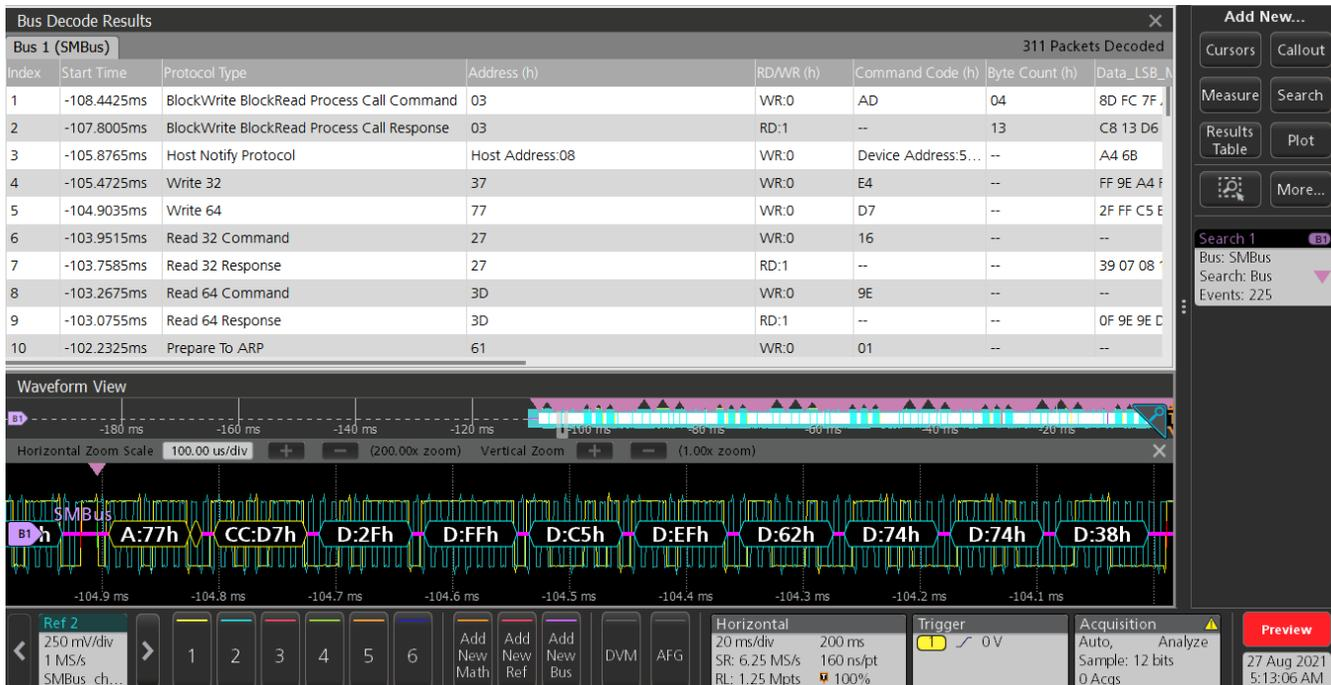
协议解码结果表为 SMBus 总线上捕获的所有包提供了一个带时间标记的表格视图。(PEC 字节设为 False)
