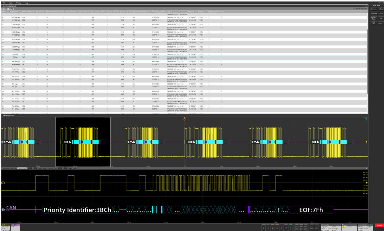
协议解码结果表提供了 CAN XL 总线上捕获的所有包的时间标记表格图。
