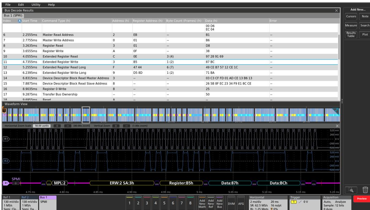
协议解码结果表为 SPMI 总线上捕获的所有包提供了带时间标记的表格视图。
