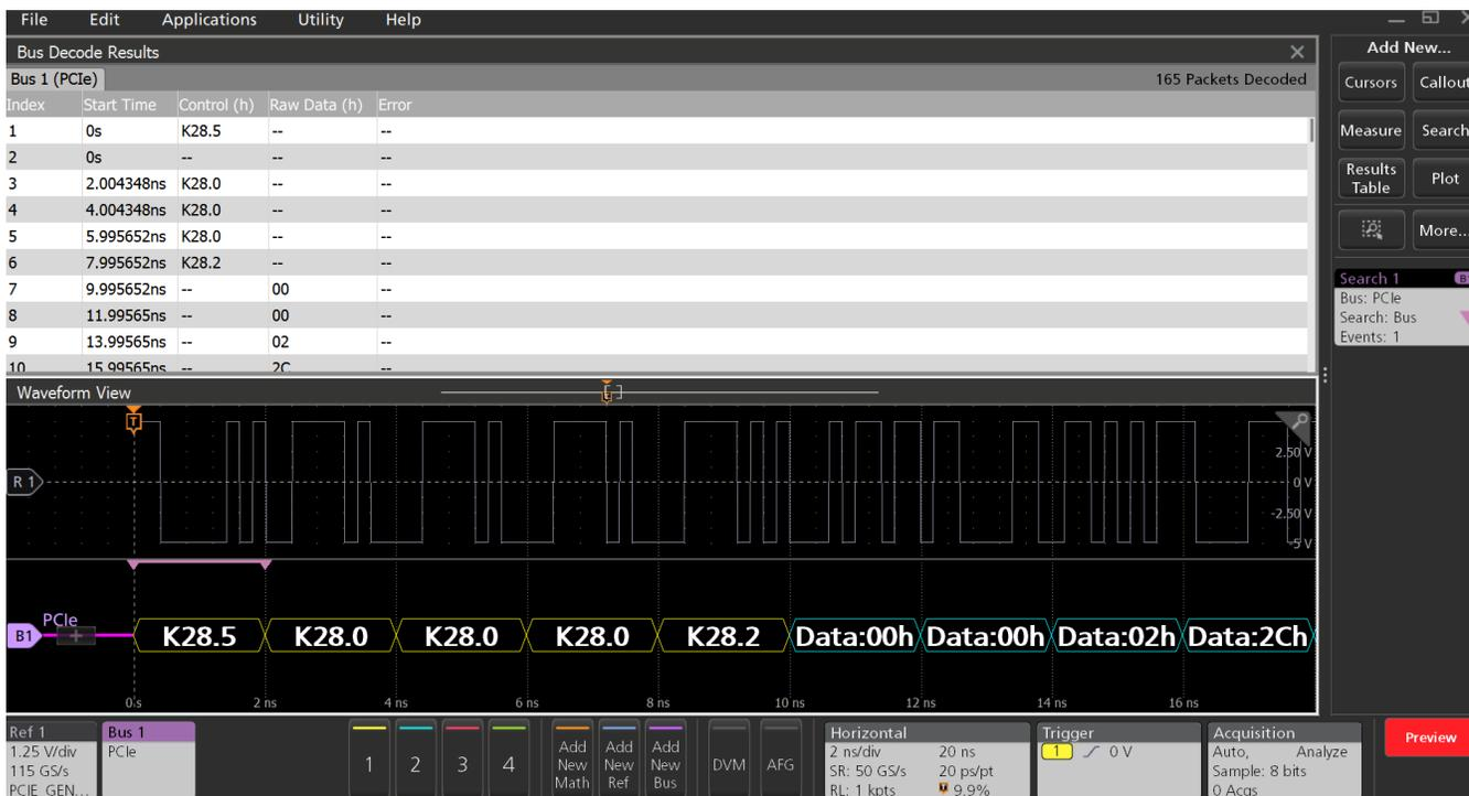
PCIe Gen 2 总线设置和MixedHex 显示，显示解码（包视图关闭）。K28.5 已搜索到1 次。
