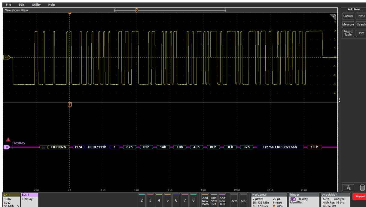
解码的 FlexRay 总线，在触发指定标识符值时采集数据。
