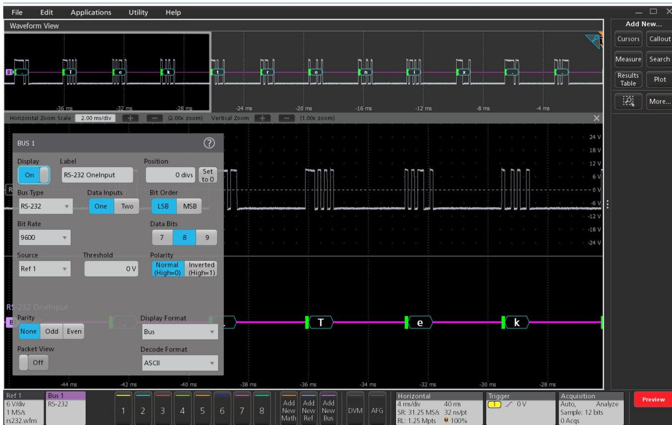
RS-232 总线设置和ASCII 显示画面，显示源信号指配、数字阈值和极性。
