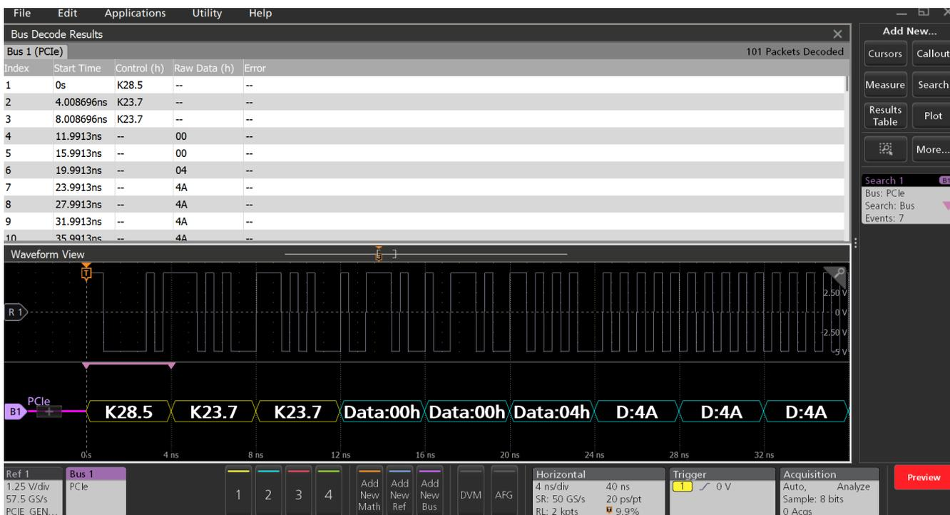
PCIe Gen 1 总线设置和MixedHex 显示，显示解码（包视图关闭）。K28.5 已搜索到7 次。
