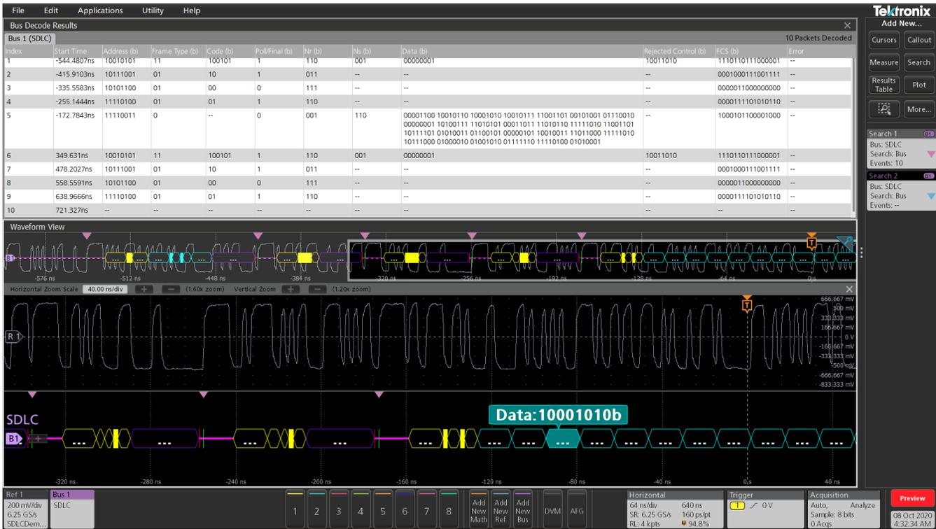
协议解码结果表为SDCLC总线上捕获的所有包提供了一个带时间标记的表格视图。
