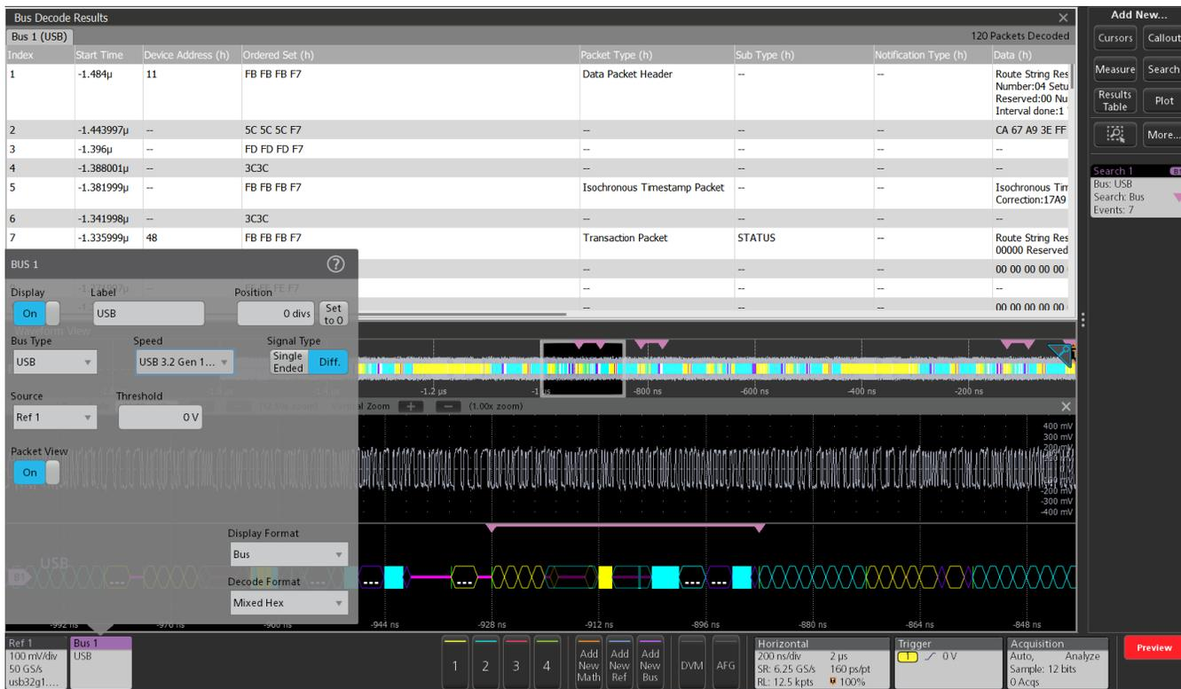
搜索USB总线，解码速度USB 3.2 Gen 1以及TP包的包视图开启。表格顶部的结果表。
