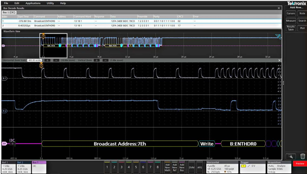
协议解码结果表为I3C总线上捕获的所有包提供了一个带时间标记的表格视图。
