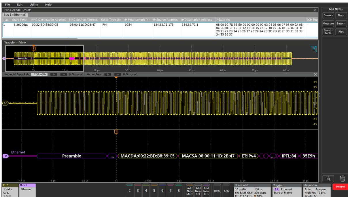
协议解码结果表提供了10BASE-T以太网总线上捕获的所有包带时间标记的表格视图。
