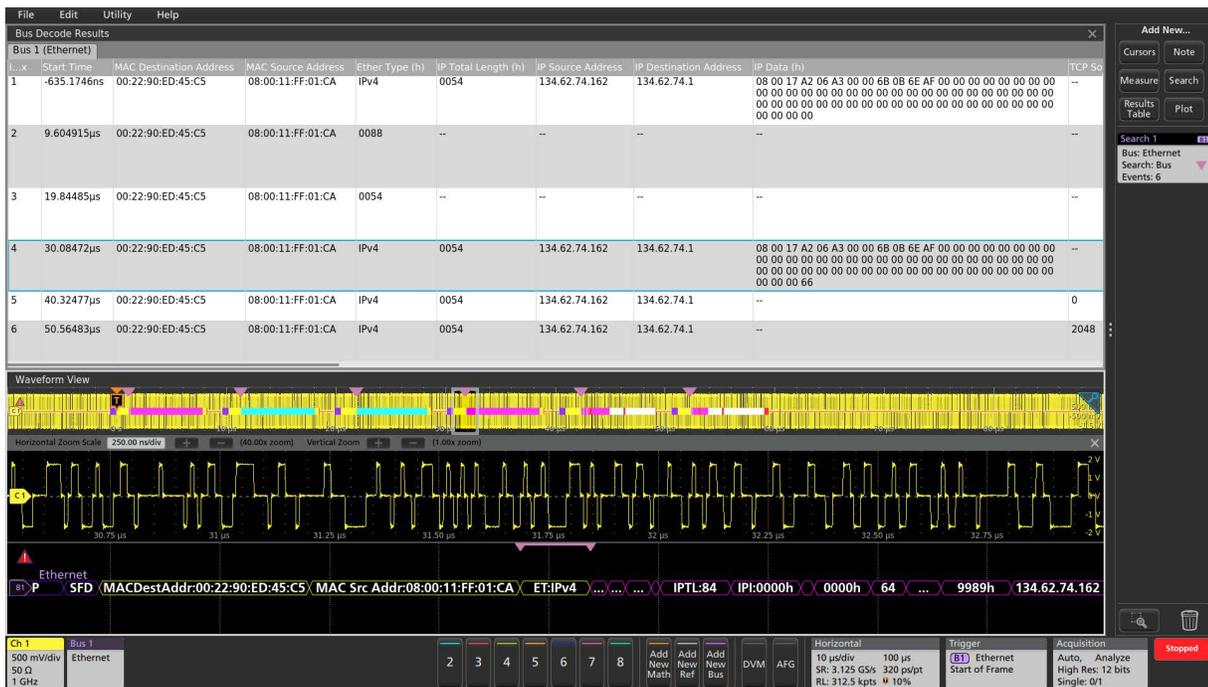
触发并自动搜索100BASE-TX以太网总线。
