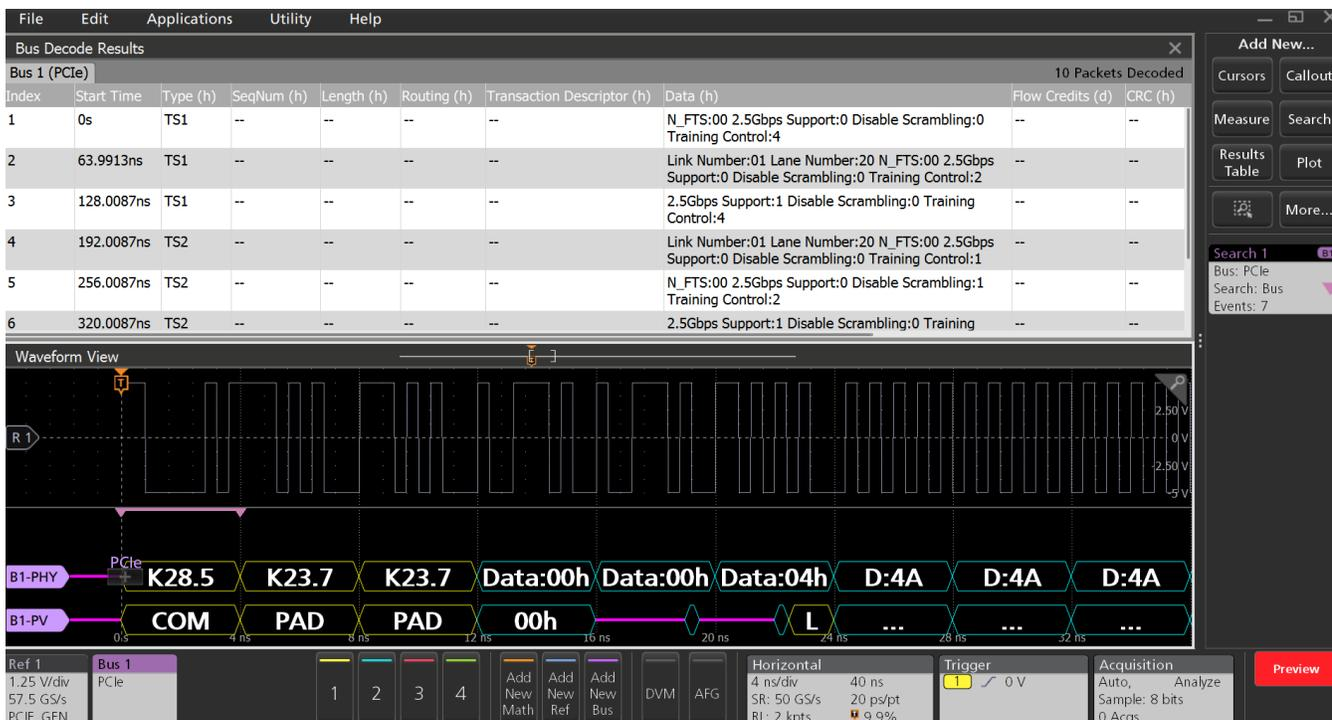
PCIe Gen 1 总线设置和MixedHex 显示，显示解码（包视图开启）。K28.5 已搜索到7 次。
