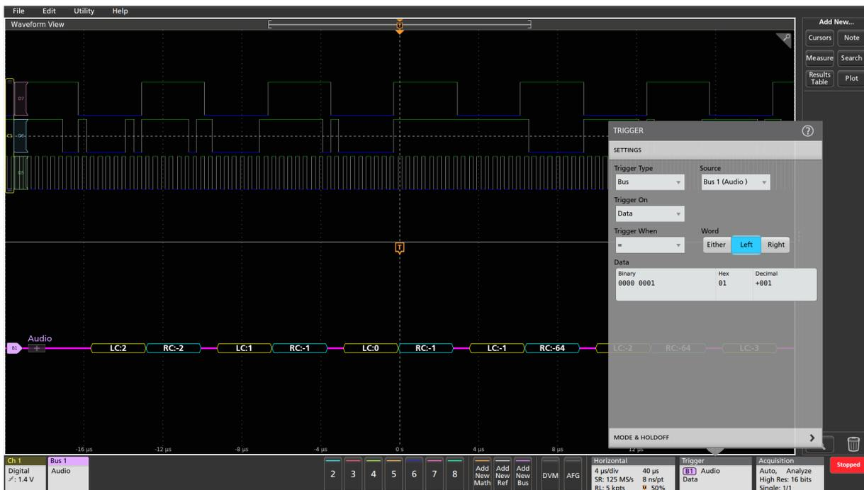
解码的I<sup>2</sup>S总线，数据值以带符号的十进制格式显示，MSO触发特定数据值。
