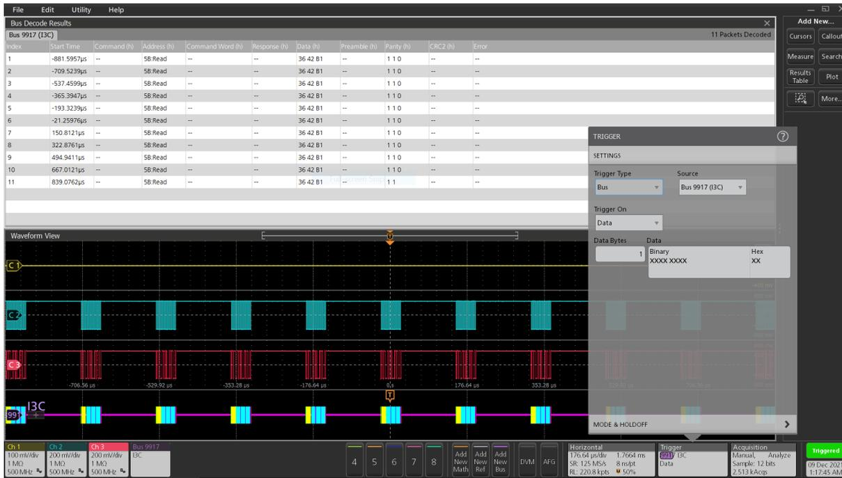
由 I3C 总线上的特定 7 位读取地址触发。
