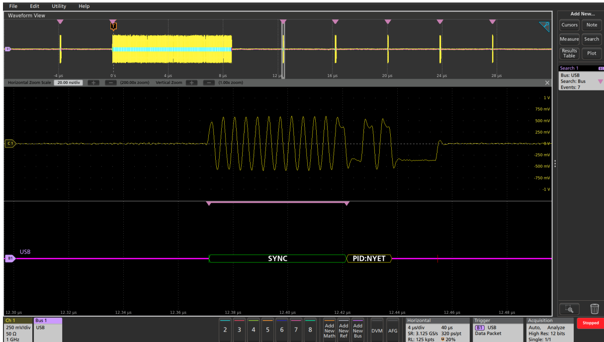
USB 2.0 バスで特定のデータ・パターンにトリガした例。シンクで自動的にサーチされている
