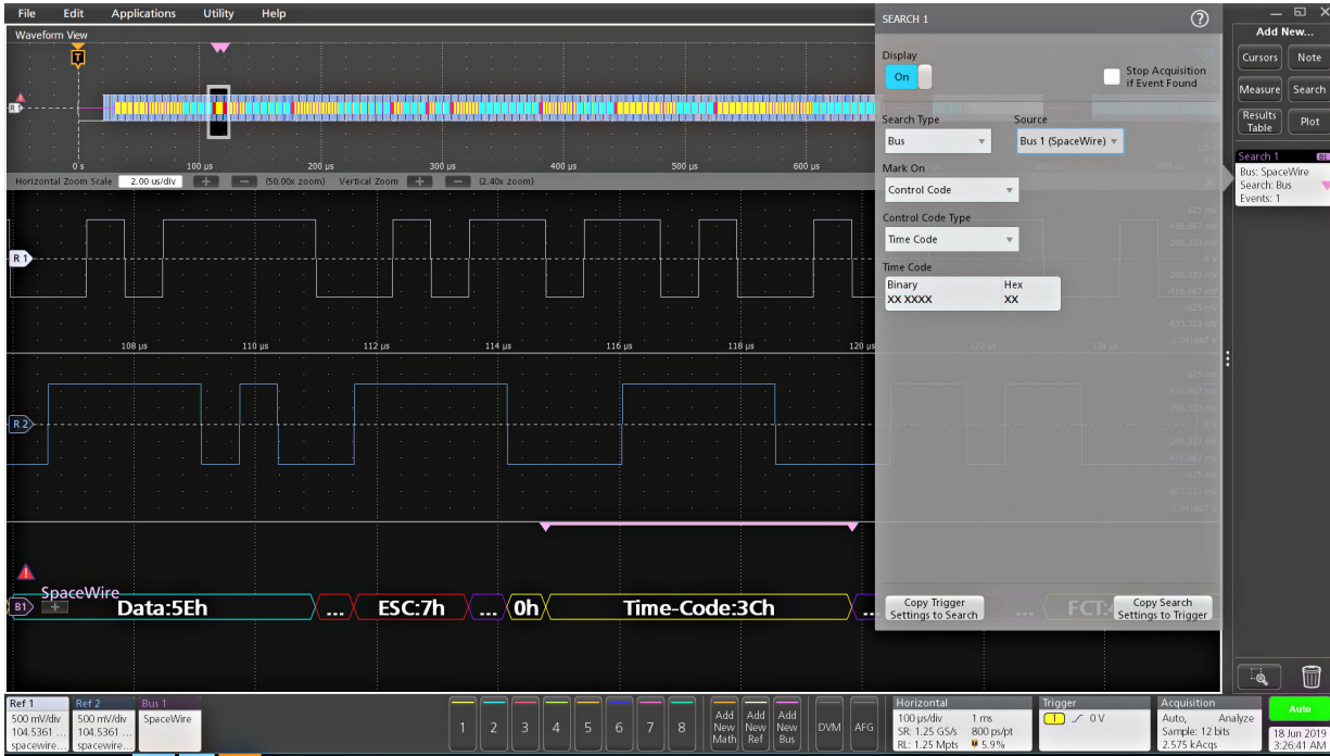
SpaceWire バスで特定のデータ・パターンでサーチした例。シンクで自動的にサーチされている
