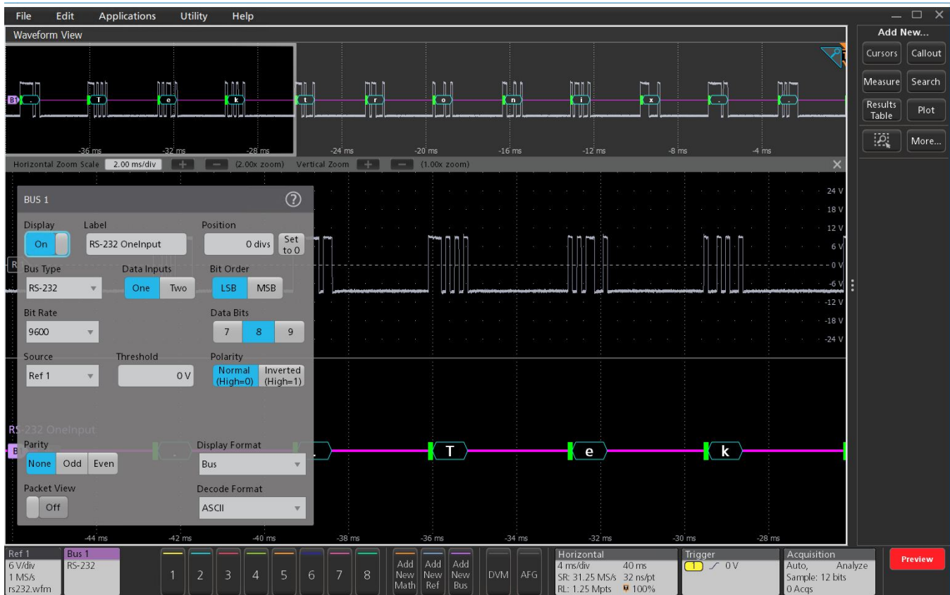
RS-232 バス設定と ASCII 表示の例。ソース信号の割り当て、デジタル・チャンネルのスレッシュホールド、および極性が表示されている
