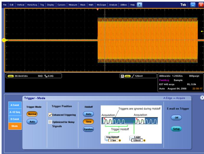
强大的示波器触发功能允许用户只捕获宽带信号的相关部分。Pinpoint 触发功能，如 A 事件和 B 事件与边沿及触发释抑相结合，可以在特定的发射机工作模式下捕获脉冲串。
