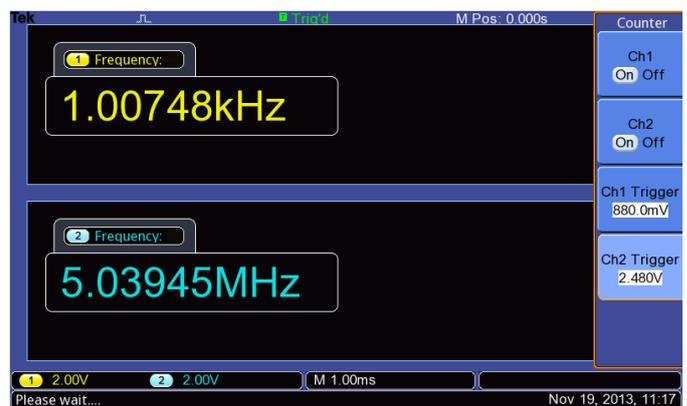
Des fréquencemètres 2 voies affichant 6 chiffres sont fournis en standard sur tous les modèles TBS1000.
