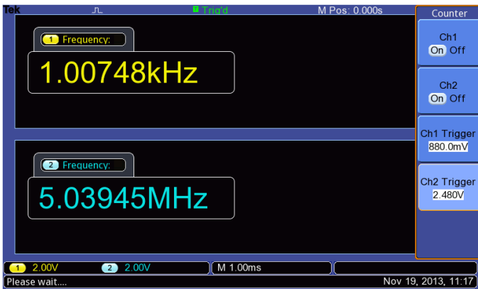
双通道 – 所有 TBS1000 示波器都标配 6 位频率计数器。
