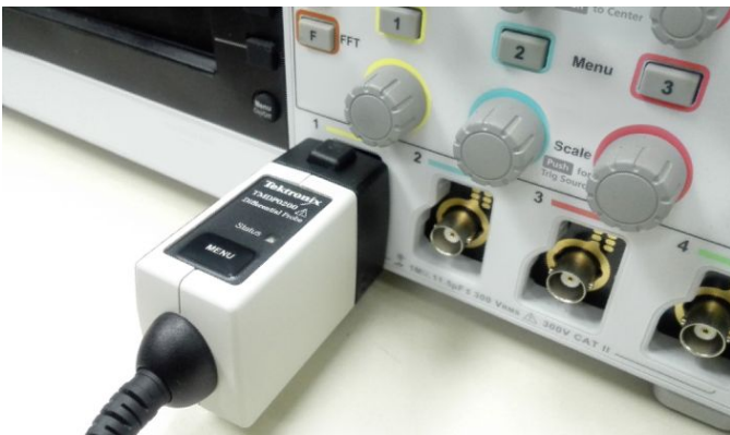
TekVPI-Tastköpfe übertragen Skaleneinstellungen, Bereiche und Statusinformationen zum TBS2000.
