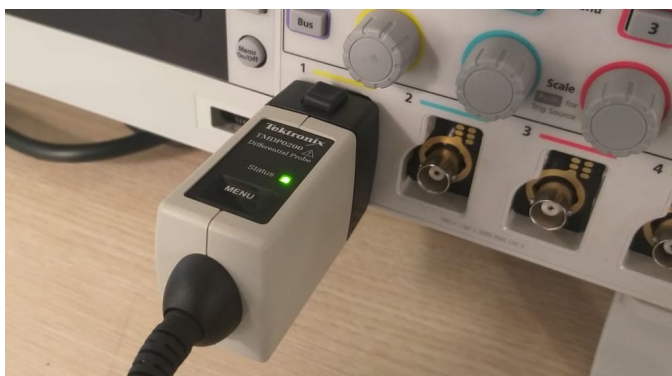
TekVPI 探头把标度设置、量程和状态传递给 TBS2000B。
