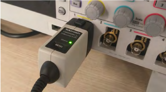
図9: TekVPI プローブは、TBS2000B シリーズと通信を行い、スケール設定、レンジ、ステータスなどの情報を送る
