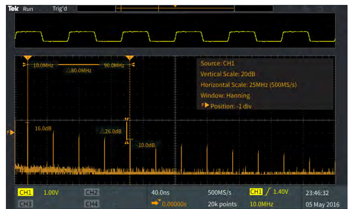
図8: 時間領域波形はFFT 波形スペクトラムの上に表示可能
