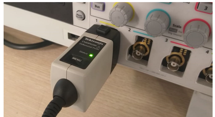
TekVPI プローブは、TBS2000B シリーズと通信を行い、スケール設定、レンジ、ステータスなどの情報を送る
