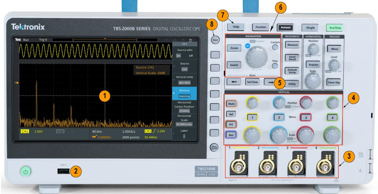
Рисунок 3. Передняя панель осциллографа TBS2000B
