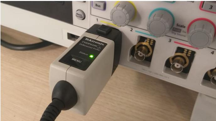
Рисунок 9. Пробники TekVPI передают прибору TBS2000B настройки масштабирования, диапазоны и информацию о состоянии.
