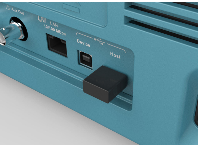
그림 10: Wi-Fi 어댑터는 통합된 설정 메뉴를 통해 구성되며, 원활한 무선 통신을 지원합니다.
