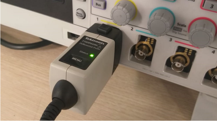
그림 9: TekVPI 프로브는 스케일 설정과 범위, 상태를 TBS2000B에 전달합니다.
