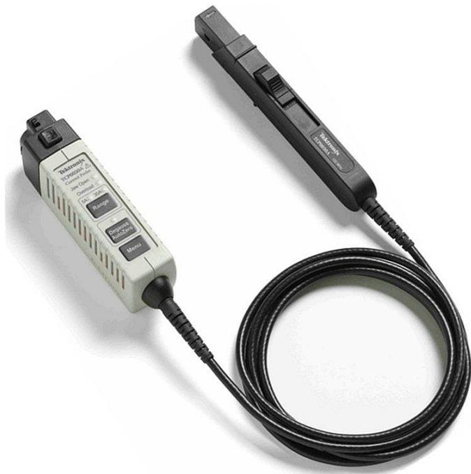
TCP0030A 型プローブは、TekVPI™ インタフェースのオシロスコープに直接接続して使用できる高性能で使いやすい AC/DC 電流プローブです。この AC/DC 電流測定プローブは、帯域が 120 MHz を超え、5 A と 30 A の測定レンジが選択できます。また、今日の電流測定に求められる、1 mA という小電流レベルの測定能力と優れた確度を提供します。
