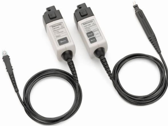
差動アクティブ・プローブを使用すると、高周波測定における優れた信号再生が可能になり、信号忠実度が向上します。TDP1500 型、TDP3500 型、TDP4000 型は入力容量が非常に低く、DUT との接続性に優れており、今日のデジタル・システム設計で必要とされる電気性能と機械性能を兼ね備えています。
