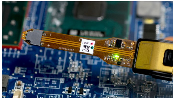
P77STFLXA 型はんだ付け用、フレックス回路アクセサリはチップ上にアクティブ・バッファ増幅器を装備
