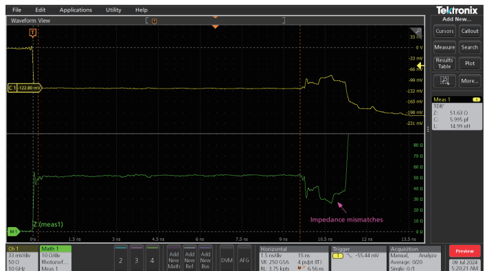
TDR 分析为上图中的走线提供阻抗波形。测量徽章中显示标记区域内波形的阻抗、电容和电感。屏幕中央较低的阻抗对应 PCB 走线中较宽的部分。
