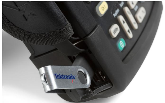
Die Standard-USB-Anschlüsse erleichtern das Speichern und Übertragen von Daten sowie die Steuerung des Geräts.
