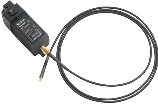
TPR1000 型 / TPR4000 型は、優れた低ノイズ性能を持ち、 $-60 \sim +60\text{V}$  の電圧範囲の DC パワーレールのリップル測定が可能なパワーレール・プローブです。テクトロニクスのパワーレール・プローブは、業界トップ・クラスの低ノイズとオフセット・レンジの広さを備えており、最高 4GHz で  $200\mu\text{V}_{\text{p-p}} \sim 800\text{mV}_{\text{p-p}}$  の AC リップル測定が可能です。
