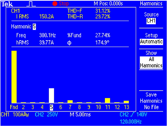
使用 TPS2PWR1 軟體進行諧波失真量測。
