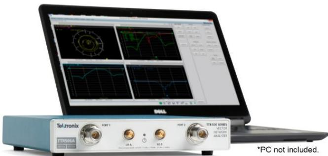
TTR500 シリーズは、ポートごとに独立した RF ソースと 3 つの RF レシーバを備えているため、1 ポートまたは 2 ポートの被測定デバイスで、優れた精度の振幅 / 位相測定が行えます。TTR500 シリーズを使用することで、DUT のすべての S パラメータ ( $S_{11}$ 、 $S_{12}$ 、 $S_{21}$ 、 $S_{22}$ ) を測定し、さまざまなフォーマットでデータを表示できます (測定機能については表を参照)。
