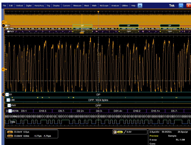
複数のレイヤを同時に表示する USB 3.0 バス表示
