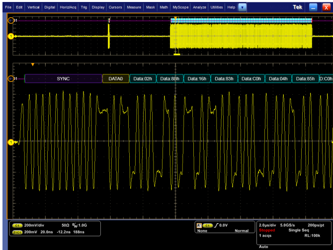
複数のデジタル・フォーマットにおけるバスの内容を自動的に表示したハイスピード USB バスのデコード表示
