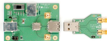
USB2SIGQUAL ハイスピード信号品質テスト・フィクスチャ・セット (USB-IF から購入可能)
