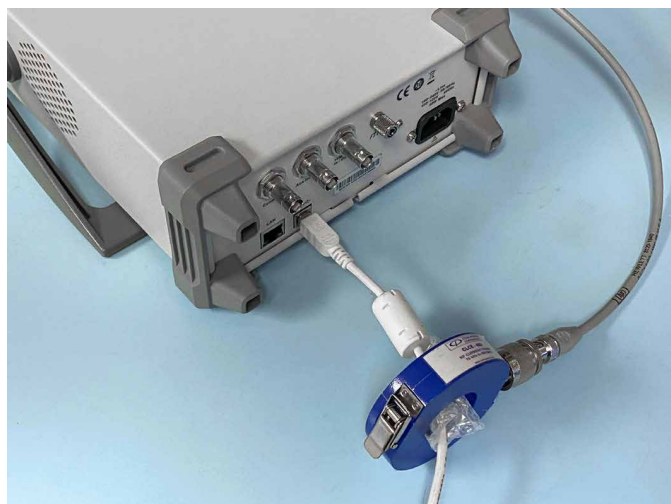
图 3. 使用电流探头测量在 I/O 和电源电缆上流动的高频电流
