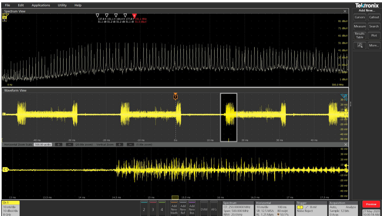
图 9. 当频谱时间移至时间域中的嘈杂数字脉冲时，电磁干扰增加了 20 dB。 通过频谱时间，可以分析这种电磁干扰脉冲是否会耦合到电缆并辐射
