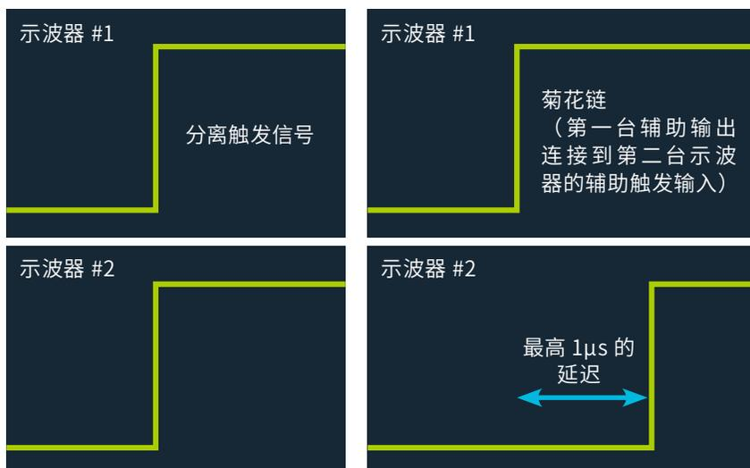
图 2: 不同的触发设置导致不同的相差或延迟。左侧的设置将同一个触发信号使用相位匹配电缆馈送至两台仪器的触发通道。右侧的设置显示了“菊花链”的影响, 其中一台示波器的辅助输出馈送至下一台示波器的辅助触发输入通道, 导致明显的延迟。
