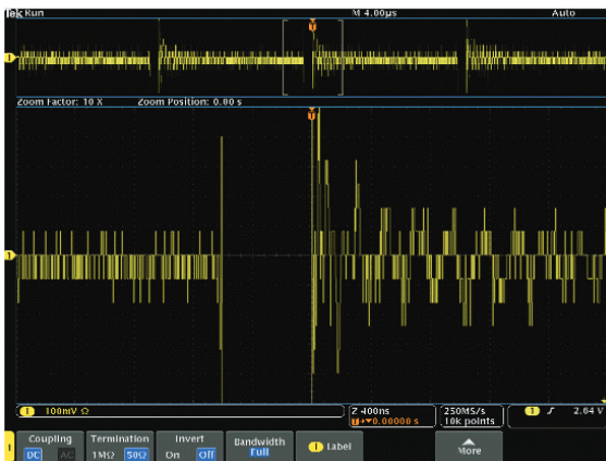
图 2. 显示了 MDO4000C 示波器的谐振现象 (分辨率为 8 位)
