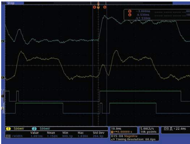
圖 52. MSO 提供了 16 個整合的數位通道，可以觀察和分析時間相關的類比訊號和數位訊號。高速時序擷取提供更高的解析度，可以揭示突波之類的窄事件。
