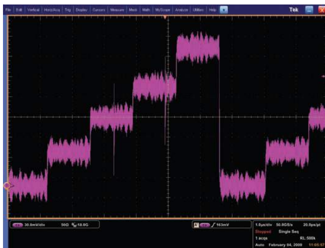
圖 24. 峰值偵測模式使得示波器能夠擷取非常短的暫態異常訊號。
