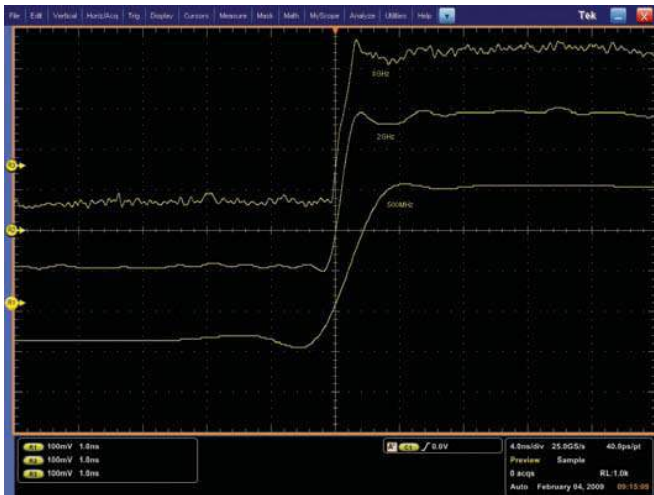
圖 45. 頻寬越高，訊號重複性準確度越高。如圖所示，這是 250 MHz、1 GHz 和 4 GHz 三種頻寬基準下擷取的訊號。
