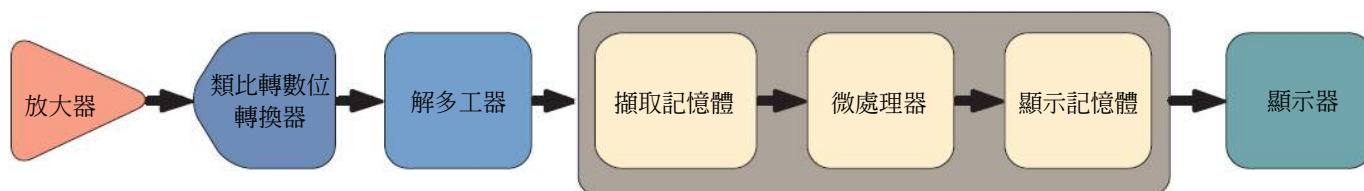
圖 12. 數位儲存示波器 (DSO) 的串列處理架構。
