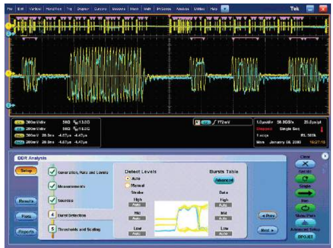
圖 57. 先進 DDR 分析工具自動完成複雜的儲存任務，如將讀/寫資料組分開及執行 JEDEC 量測。
