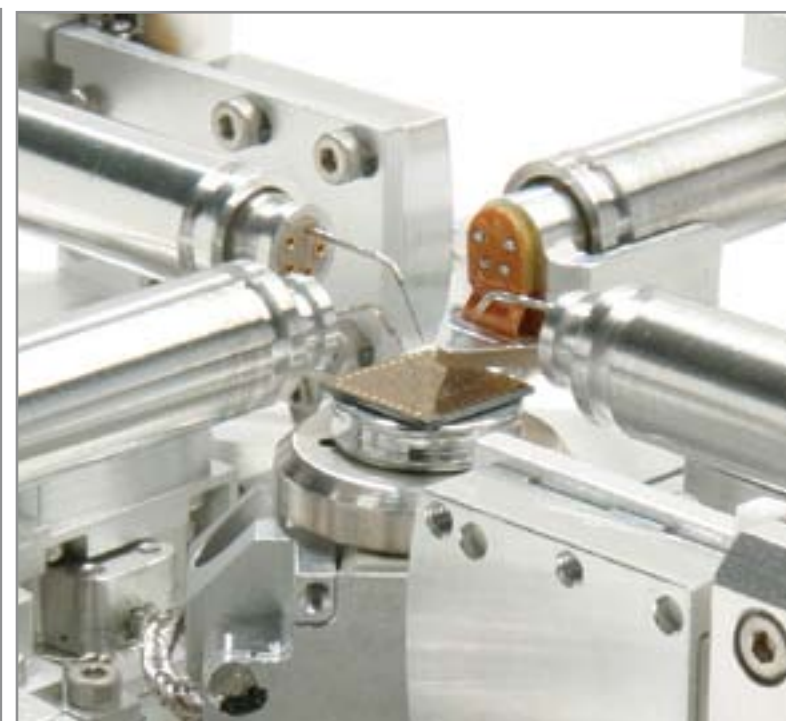
図 2. ナノスケール構造を探索中のナノマニピュレータ: CNT の直接電氣測定に使用される低インピーダンスプローブ接点 (全体を巨視的に見る)。ナノマニピュレータ ヘッドアセンブリの写真。(写真提供: Zyvex Corporation)
