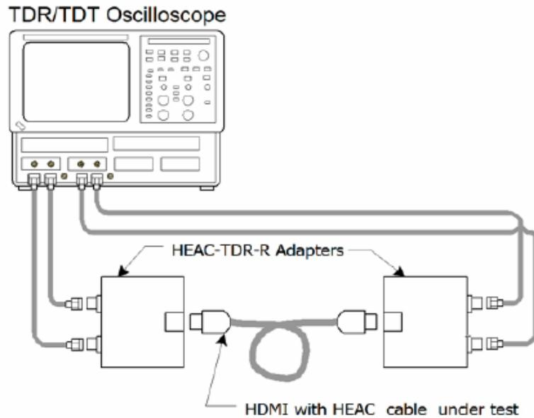
Tektronix – Impedance/attenuation
