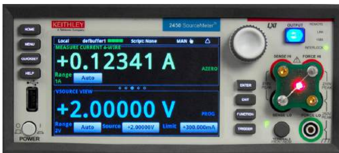
圖 1. 機型 2450 SourceMeter SMU 儀器量測紅色 LED 的 I-V 特性分析。
