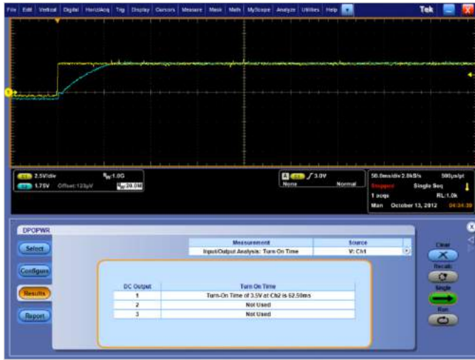
圖 8. MSO-5000 示波器上 DPOWPR 軟體的導通時間測試螢幕擷取畫面，顯示量測導通時間 (紅色強調顯示)。
