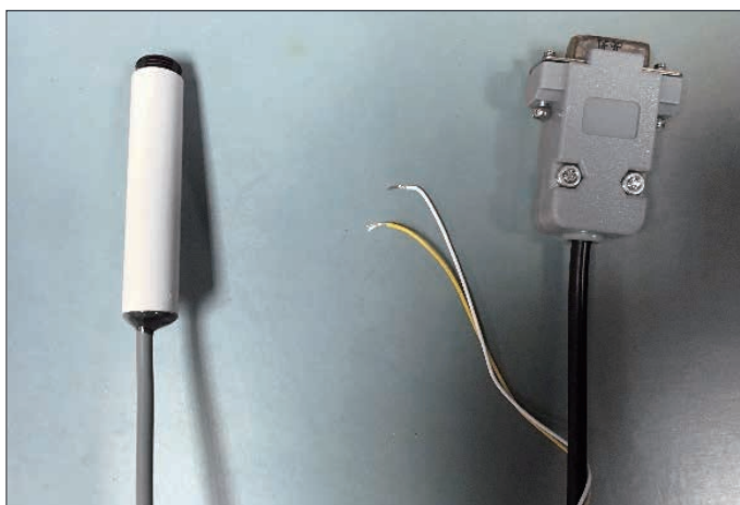
図4. 相対湿度プローブをDB9とカードリーダーに接続
