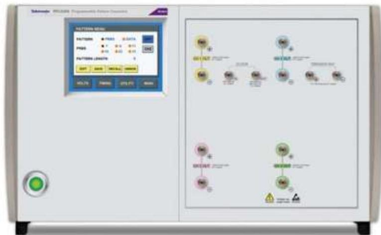
可以独立编程的输出通道支持进行全方位多路测试。数据输出拥有 100 ps 的可调节偏移/延迟范围(独立于通道)。(图中是 32 Gb/s 版本)
