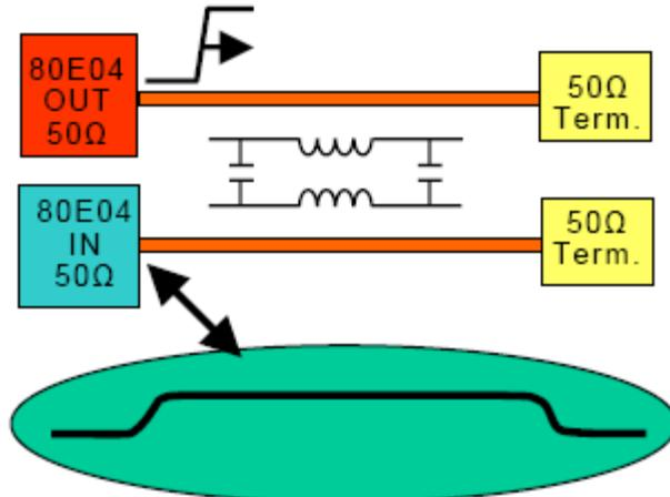
所有线路必须端接以消除反射
