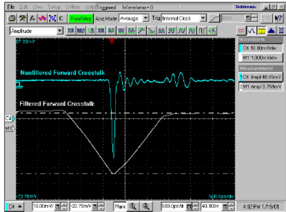
所有线路必须端接以消除反射
