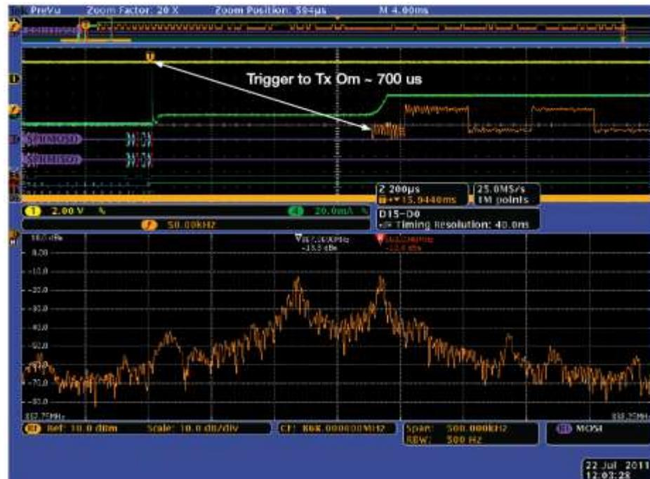
使用MOSI总线数据触发，查看频率随时间变化曲线
