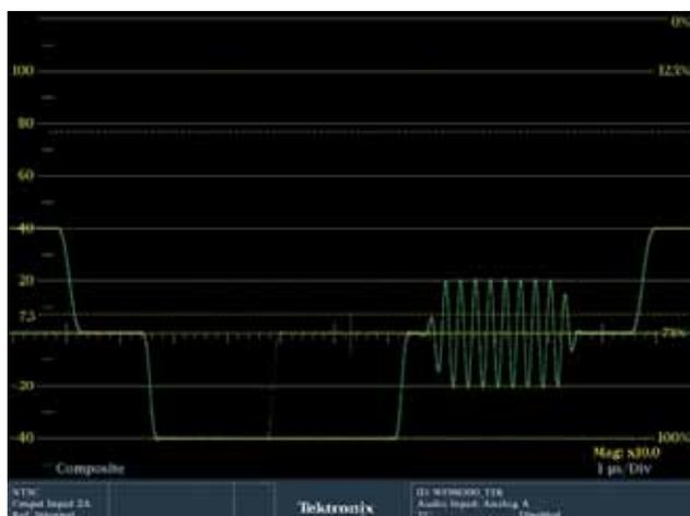
图 15. NTSC 制的信号波形和矢量显示。
