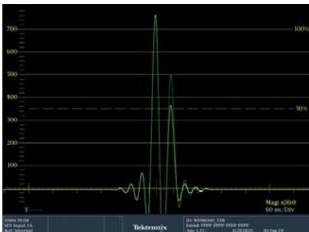
图 19. 数字 SDI 信号中的 EAV/SAV 同步字通过 WFM8300 时，屏幕上显示 Y 通道的 XYZ 脉冲波形。
