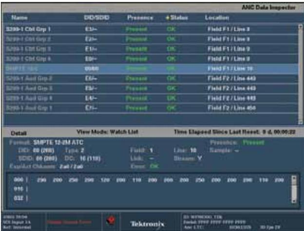
图 1C. ANC 数据显示以及 SMPTE 12-2 时间码在状态栏中的显示。
