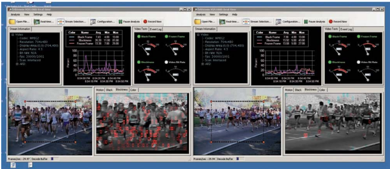
图 9. 两个编码器对同一视频内容分别采用不同的压缩编码：其中一个压缩码率为 2 Mbps，另一压缩码率为 8 Mbps。
