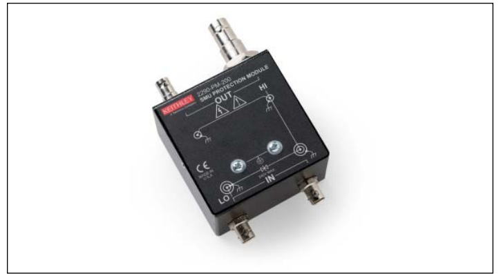
图3 2290-PM-200型防护模块实现200V源测量单元（SMU）仪器与测试电路的安全连接。无论测试电路中是否使用2290-5型5kV或2290-10型10kV高压电源，都可以使用该防护模块。
