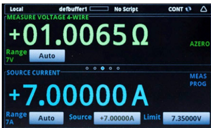
图7 2460型仪器主屏幕前面板图
