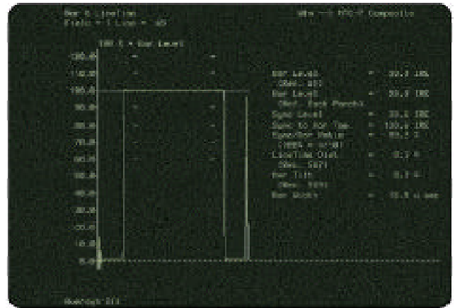
► 图3 VM700T 使用 NTC-7 复合测试信号行作白条脉冲和行时间测量
