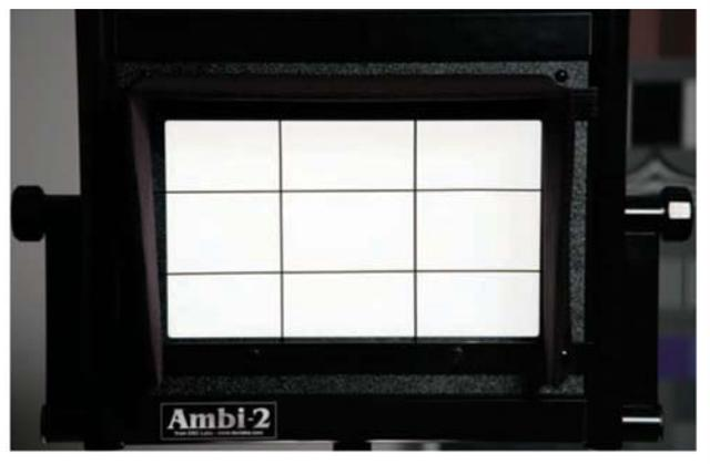
图 1b. 带有透明光栅的 Ambi 照明设备。
