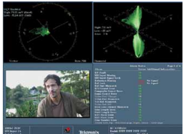
图 30. 这是第四种 LQV 显示的组合方式，它将仪器配置为一个 LQV 阴影（或者为高光）显示并连带一个钻石显示，这样可以在调整 LQV 的同时监视是否会带来色域违规。
