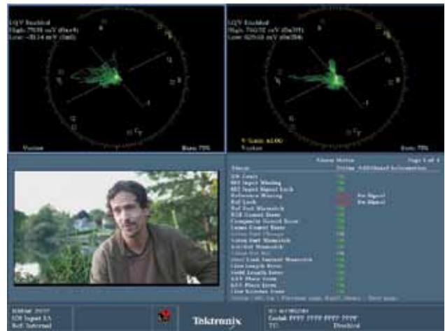
图 19. WFM 和 WVR 5200 可以提供两个分屏的信号迹线显示。另外两个分屏则只能提供非迹线显示, 例如图像监视显示、音频条和状态 (Audio bar and Status) 显示。
