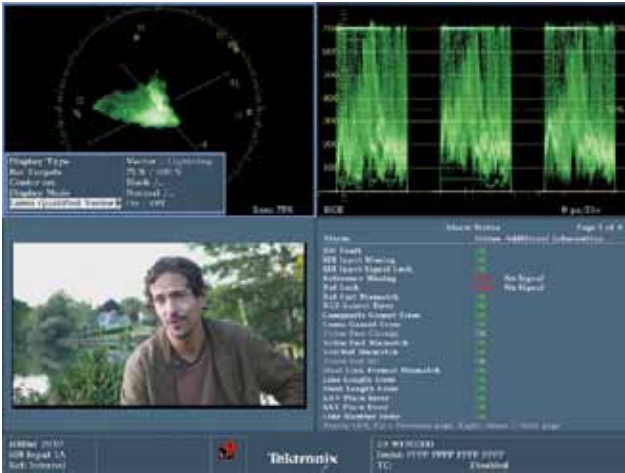
图 20. 注意位于屏幕左上方的分屏四周有蓝色边框，表明该象限（分屏）已被选中。这种选择可以使用仪器面板上的缩略图 (Thumbnail) 按钮或者显示选择 (Display Select) 按钮来完成。
