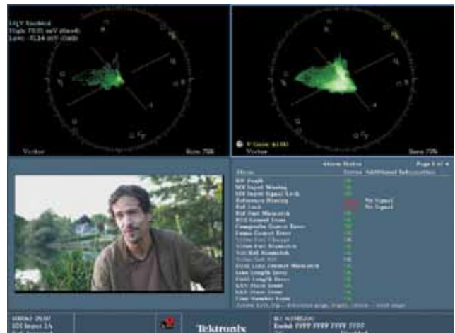
图 28. 这是第二种 LQV 显示的组合方式，它将仪器配置为一个 LQV 阴影显示并连带一个标准矢量显示。
