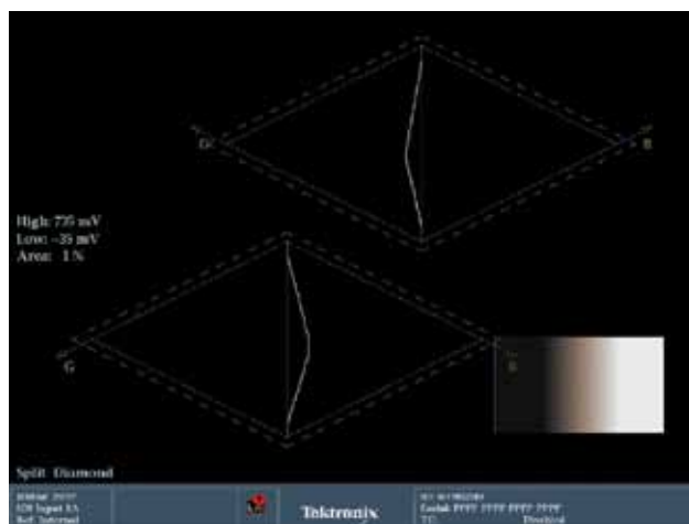
图 12. 在本图的分离钻石显示中，被测试的视频信号与图 11 相同，即均为由黑到白的斜坡测试信号，不过该信号图像的中间调偏暖，即偏向红黄色。由图 12 可见，这种偏色在钻石显示中可以十分清楚地观察到：信号迹线在上钻石的最宽连线处向左即向钻石绿边轴扭斜，而在下钻石的最宽连线处向右即向钻石红边轴扭斜。而上下两钻石的最宽连线的中点处即表示为中间调。信号迹线在下钻石中偏向红边轴是很容易理解的。至于信号迹线在蓝 / 绿钻石中偏向绿边轴，是因为该信号也带有微黄色，而黄色的色相恰与蓝色相反，且黄色也是红和绿的合成色，这就解释了为什么该信号迹线在上钻石的中心处偏向绿边。
