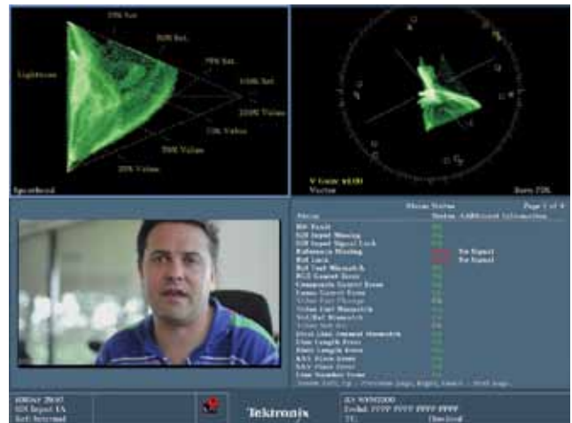
图 40. 这是一个平衡良好的图像显示。图中饱和的彩色向右扩展。图像迹线的主要部分自上而下地沿着左边轴。
