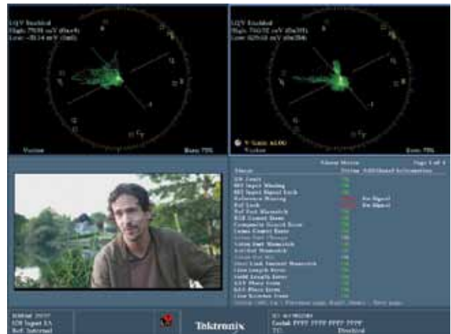
图 22. 屏幕上方的两个分屏分别为阴影区 (左分屏) 和高光区 (右分屏) 的亮度限定矢量显示，且两个分屏均已设置了高亮度 (LUMA HIGH) 和低亮度 (LUMA LOW) 的电平值。
