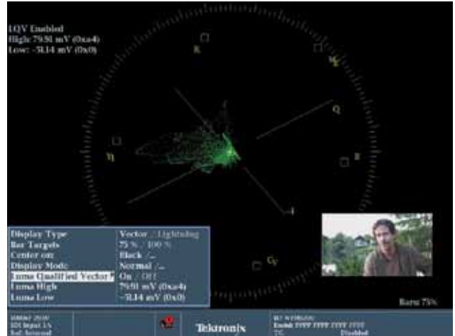
图 21. 可以将图 20 左上方的分屏显示调出以得到全屏显示，这样可以更加清楚地观察到相应的选择菜单。图中高亮度 (Luma High) 选项已被选中，可以使用仪器面板上的圆盘旋钮 (General dial) 来调整亮度电平范围。
