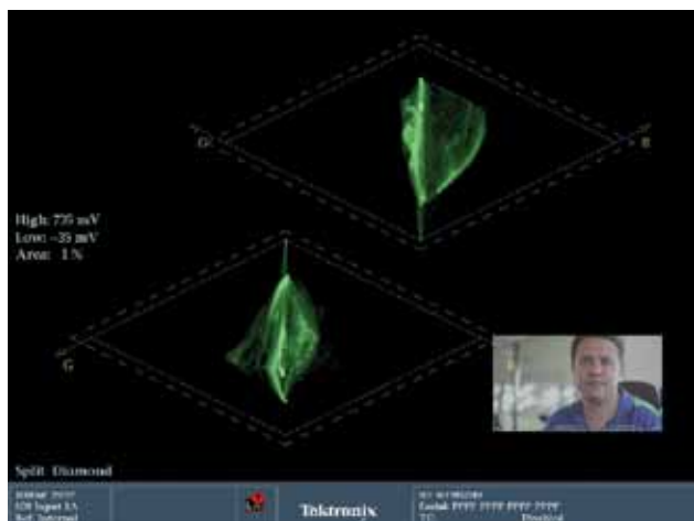
图 10. 本图分离钻石显示中的图像与图 9 显示的图像相同，不过本图中图像的增益较低，图中阴影部分显得较为明亮或者说（黑色电平）有所提升。注意信号迹线没有延伸到上钻石的顶部和下钻石的底部。如果移动信号迹线使其远离中心点（指上下两钻石相交处），这时图像的黑色电平升高而黑色变淡；如果移动信号迹线使其远离上钻石的顶部和下钻石的底部，则表明图像的增益降低。
