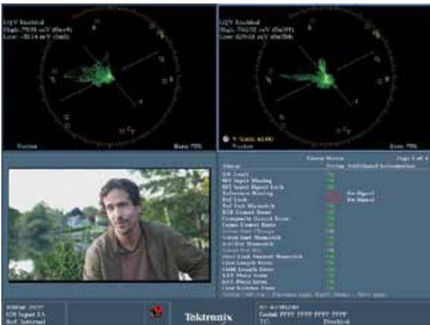
图 27. LQV 高光区和阴影区显示。这是第一种 LQV 显示的组合方式，它将仪器配置为一个 LQV 高光显示和一个阴影 LQV 显示。
