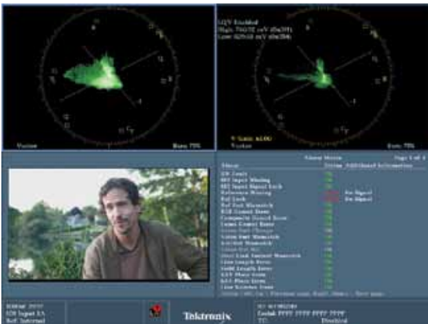
图 29. 这是第三种 LQV 显示的组合方式，它将仪器配置为一个 LQV 高光显示并连带一个标准矢量显示。
