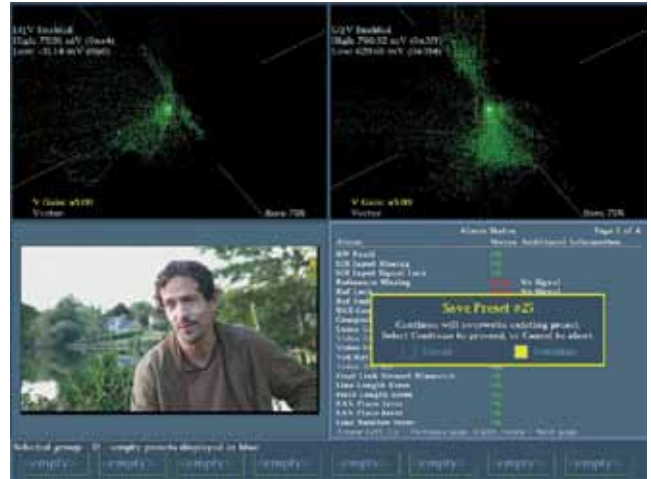
图 25. 图示为将这个预置项保存到 D1 组的操作。您还可以保存到任何 empty(空白组)或者未使用的预置项组。
