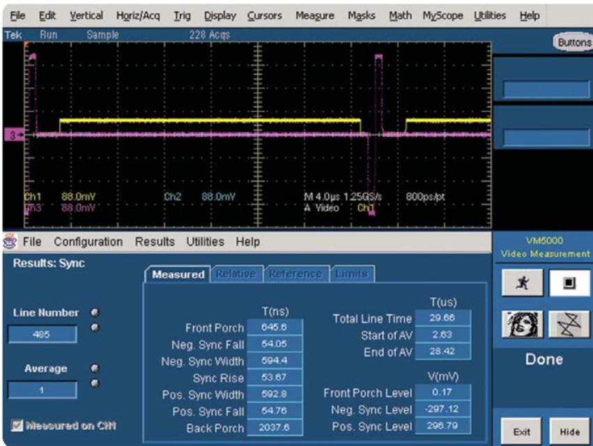
► 图 21. HD 信号的 VM5000 同步测量结果。
