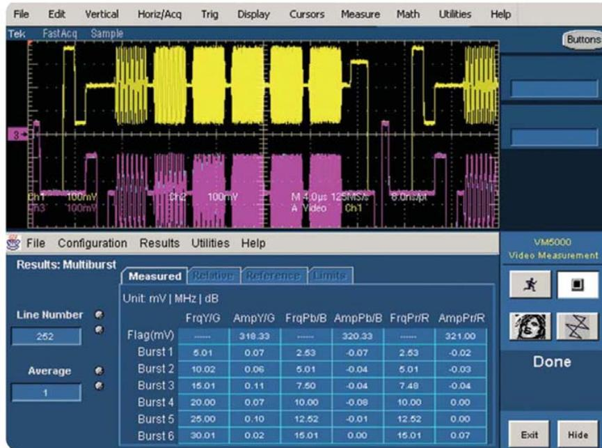
► 图 12. 某机顶盒的 1080i 格式信号的多波群输出。
