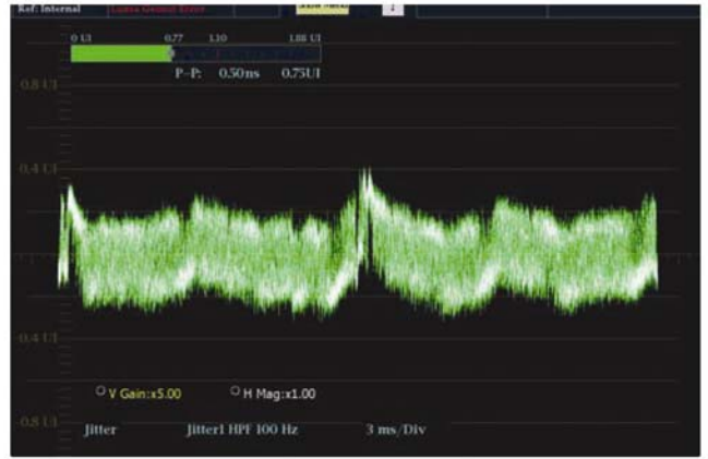
100Hz의 대역 통과 필터를 사용한 트레이스는 보다 수평적이며 지터 판독값은 0.75UI입니다. 이는 100Hz 미만의 심각한 지터 성분이 존재함을 가리키며 본선에서 발생할 확률이 높습니다.
