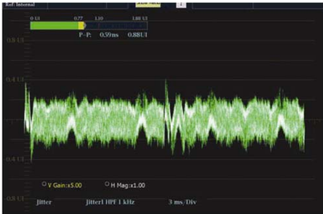
1kHz을 선택한 지터 판독값은 이제 0.88UI가 됩니다. 이 값은 신호내에서 지터가 약간 증가한 것을 보여주며 이 필터가 적용된 필드 레이트에서 발생된 차등화를 관찰 할 수 있습니다. 이는 대역 통과 경계상에 존재하는 지터의 성분을 가리킵니다.
