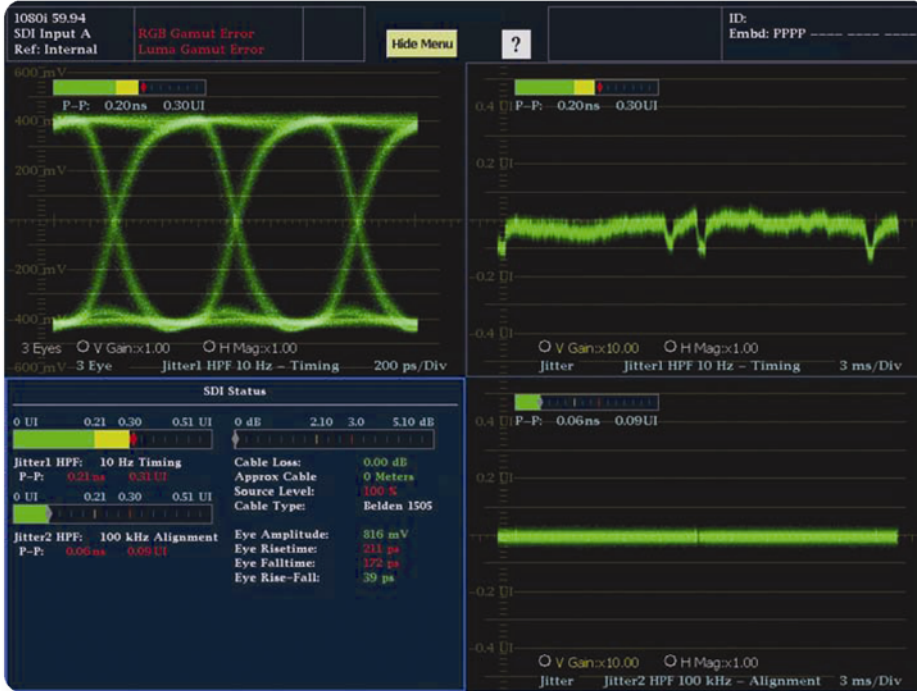
▶ 그림 13. 타이밍 및 지터 정렬의 동시 측정
