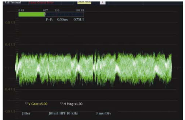
10kHz 필터가 신호에 적용되면, 지터 판독값은 0.75UI가 됩니다. 지터 파형의 트레이스가 보다 수평에 가까워집니다.
